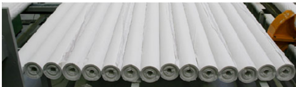
Figura 7 - Accumulatore di log - Linea MTC
